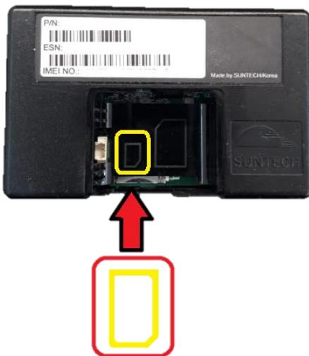
**!** Atenção: Recomendamos que o uso do SIM Card Micro (3FF) seja utilizado com a base de metal para baixo encostando na placa para que tenha conectividade. A utilização de SIM Card adaptados e de outros formatos podem danificar o equipamento, levando à perda de garantia.
