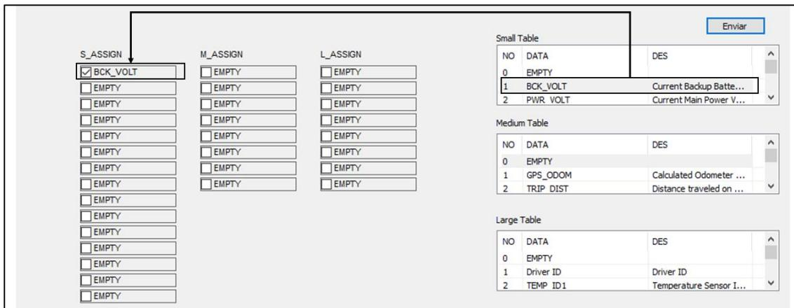
É possível configurar os dados e as informações adicionais que serão transmitidos nos alertas do dispositivo. Esta configuração é realizada através do menu **ASSIGN HEADER (ALT)** do configurador Synctrak. Existem 3 classificações de informações adicionais que podem ser adicionados aos alertas e classificamos conforme as tabelas, small table, medium table e large table.
